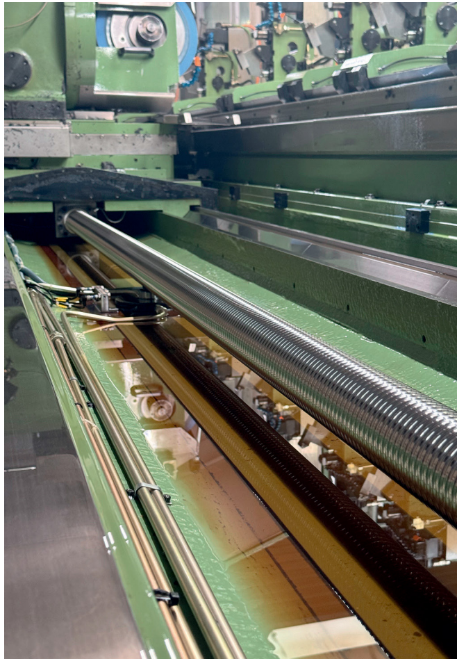
Blick in eine Innengewindeschleifmaschine mit nachgerüstetem Kugelgewindetrieb von Kammerer
