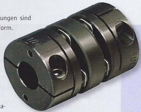
Lamellenkupplung von Ruland aus schwarz eloxiertem Aluminium in Doppelgelenkausführung mit Klemmnaben
