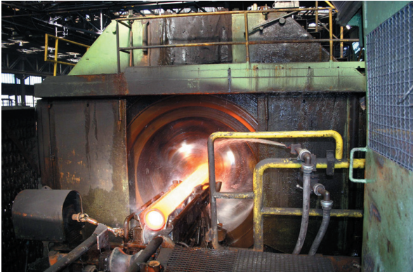
NKE'nin silindirik makaralı özel rulmanı, planet tipi eğik haddeleme tezgahının destek rulmanı olarak kullanılır.
