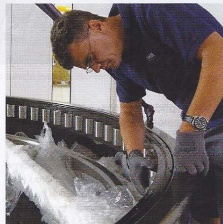
Montáž speciálního válečkového ložiska s vnějším průměrem 3,3 m ve společnosti NKE
