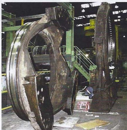
Opěrný prstenec s vnitřním kruhem ložiska (vlevo), skříň ložiska s válečky, klec a vnější kruh (vpravo)
