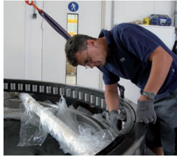
Montaje en NKE Austria del rodamiento especial de rodillos cilíndricos con diámetro exterior hasta 3,3 m.
