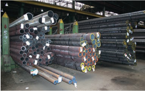
Los tubos de acero sin costura de ESW ofrecen una variedad de posibilidades de aplicación, por ejemplo como tubos de transporte en distancias largas para gas y petróleo, en la industria mecánica y de construcciones metálicas y en la industria automovilística.
