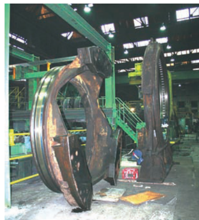
El anillo de apoyo con anillo interior del rodamiento (izquierda), la carcasa del rodamiento con rodillos, jaula y anillo exterior (derecha).
