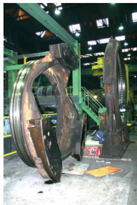
(sopra) L'anello d'appoggio (a sinistra), l'alloggiamento del cuscinetto con rulli, la gabbia e l'anello esterno (a destra). (a sinistra) Assemblaggio del cuscinetto a rulli cilindrici speciali con un diametro esterno di 3,3 m presso NKE Austria.
