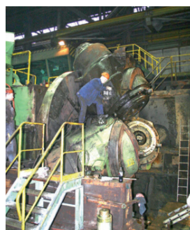
(sopra) I tubi senza saldatura di ESW offrono molteplici possibilità d'impiego, per esempio come condotte a distanza per gas e petrolio, nelle acciaierie e nel settore meccanico nonché nel settore automotive. (sotto a sinistra) Il cuscinetto a rulli cilindrici speciale di NKE viene impiegato come cuscinetto d'appoggio del laminatoio obliquo epicicloidale. (sotto a destra) Montaggio delle teste di laminazione nel laminatoio obliquo epicicloidale, qui senza anelli scorrevoli e alloggiamento del cuscinetto d'appoggio.
