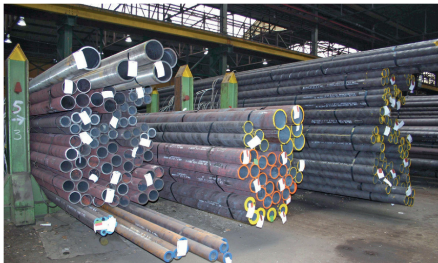
(sopra) I tubi senza saldatura di ESW offrono molteplici possibilità d'impiego, per esempio come condotte a distanza per gas e petrolio, nelle acciaierie e nel settore meccanico nonché nel settore automotive. (sotto a sinistra) Il cuscinetto a rulli cilindrici speciale di NKE viene impiegato come cuscinetto d'appoggio del laminatoio obliquo epicicloidale. (sotto a destra) Montaggio delle teste di laminazione nel laminatoio obliquo epicicloidale, qui senza anelli scorrevoli e alloggiamento del cuscinetto d'appoggio.
