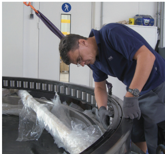
(sopra) L'anello d'appoggio (a sinistra), l'alloggiamento del cuscinetto con rulli, la gabbia e l'anello esterno (a destra). (a sinistra) Assemblaggio del cuscinetto a rulli cilindrici speciali con un diametro esterno di 3,3 m presso NKE Austria.
