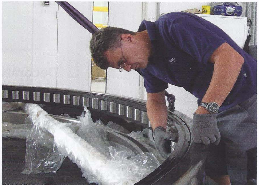
Een medewerker van NKE is bezig met de samenstelling van het cilindrische rollager met een buitendiameter van 3,3 m
