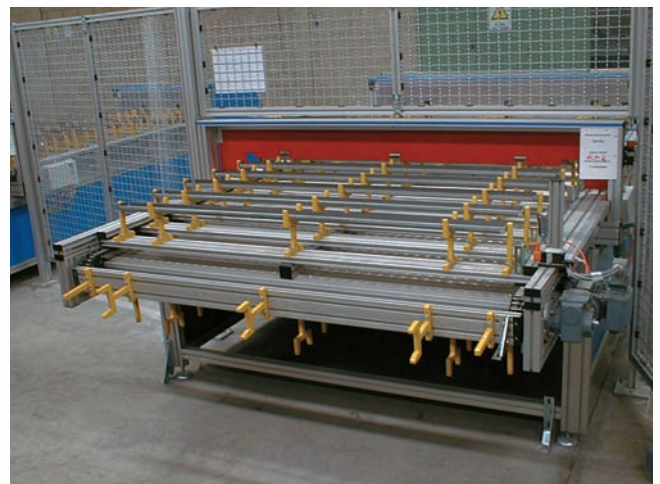
Transportador de recirculación vertical con portapiezas con un ancho de 2.000 mm: las piezas del chasis son transportadas hacia una célula de soldadura. Over-under conveyor with 2,000 mm wide workpiece carriers: delivers car body parts to a welding cell.
