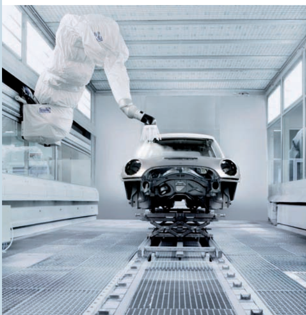
I robot di verniciatura Ecopaint sono ottimizzati per la verniciatura automatica di superfici di carrozzerie e di altri componenti nella verniciatura di serie.
