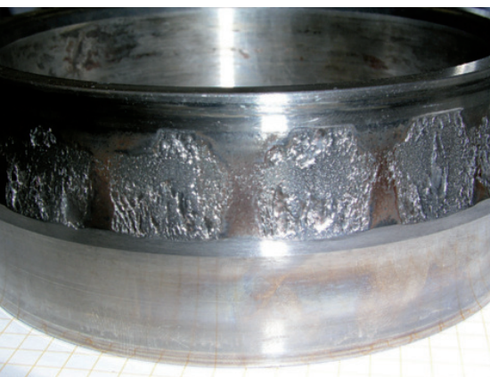
Un cuscinetto danneggiato a causa di un montaggio improprio.
